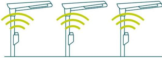
Se gli apparecchi di illuminazione sono già presenti, è possibile posizionare sul palo il Kit connettore, un'unità compatta che funziona con la maggior parte degli apparecchi.
