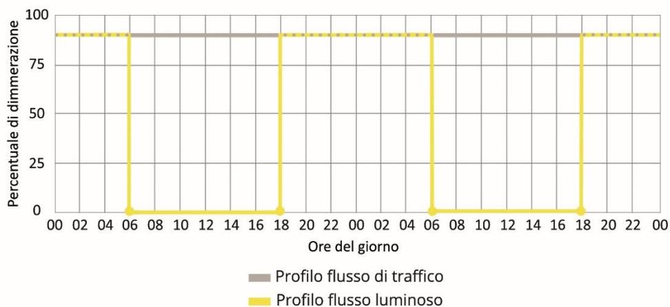
Figura 4.4.1 – Profilo luminoso di un sistema a piena potenza
