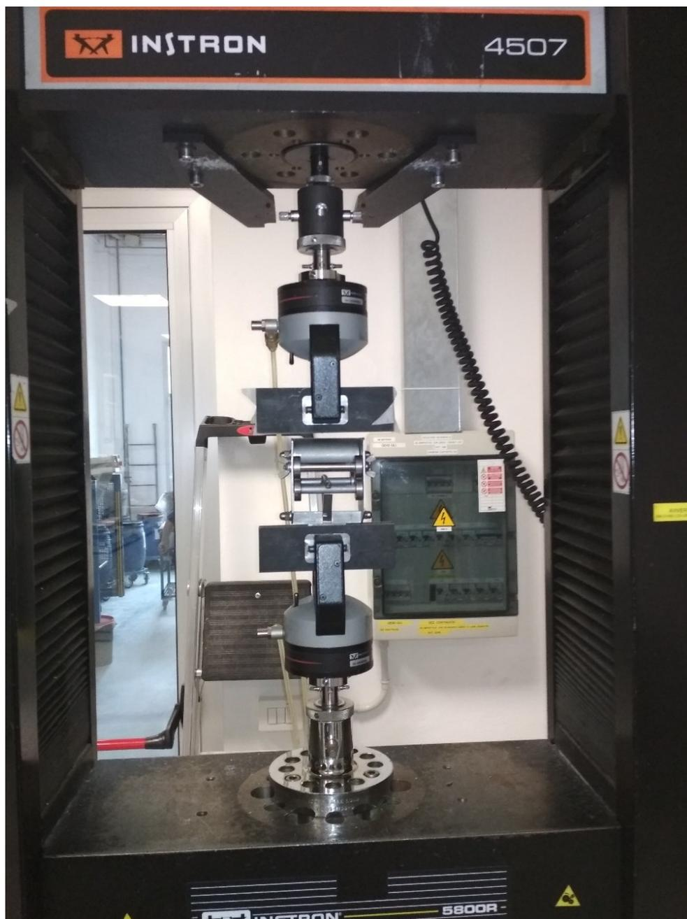
INSTRON mod. 4507 Azionamento elettromeccanico (motore elettrico in D.C. a magneti permanenti) Capacità: 100 kN.
