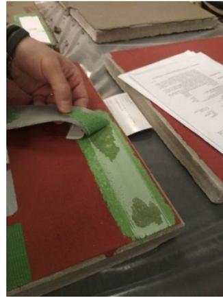
PROVA DI RESISTENZA AL PEEL (01/04/19)
