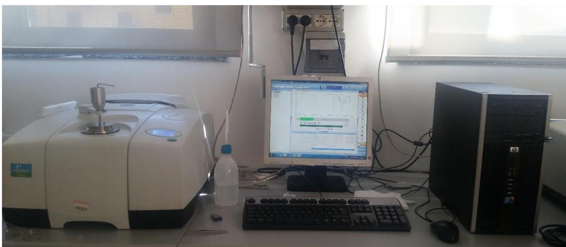
**Figura 19: Fotografia dell'apparecchiatura Frontier FTIR Spectrometer adoperata per la caratterizzazione delle membrane**
