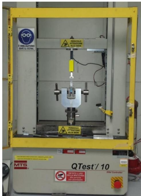
**Figura 21: MTS QTest/10 utilizzato per le prove meccaniche**
