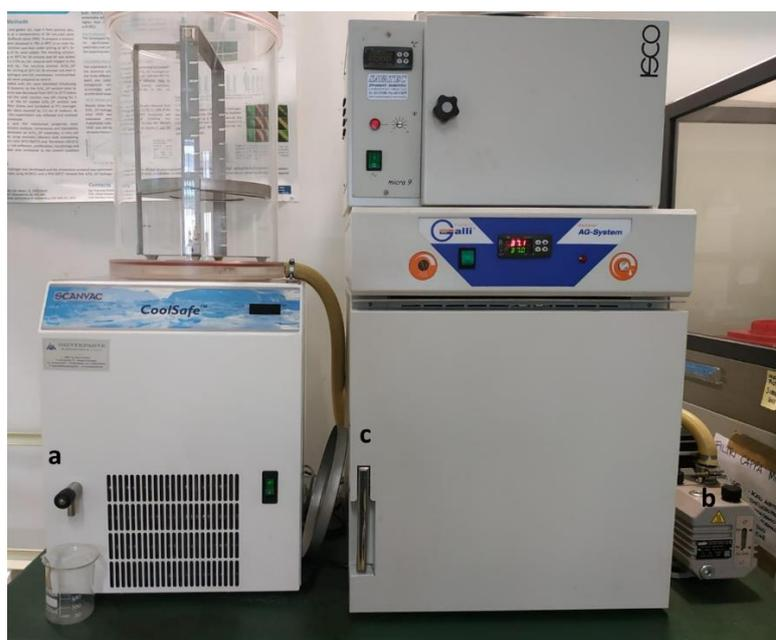
**Figura 20: a) Liofilizzatore Scanvac Coolsafe 55-4; b) Pompa a vuoto; c) Incubatore**
