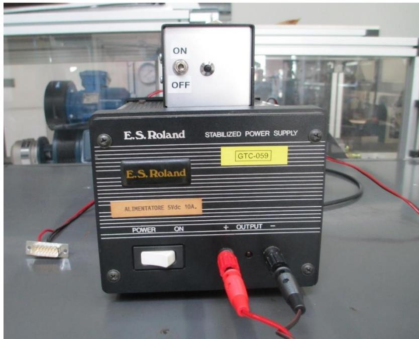
Figura 4.4- Alimentatore di tensione collegato tramite fili bipolari a LED (in alto) e collegamento per il canale CH 7 della centralina
