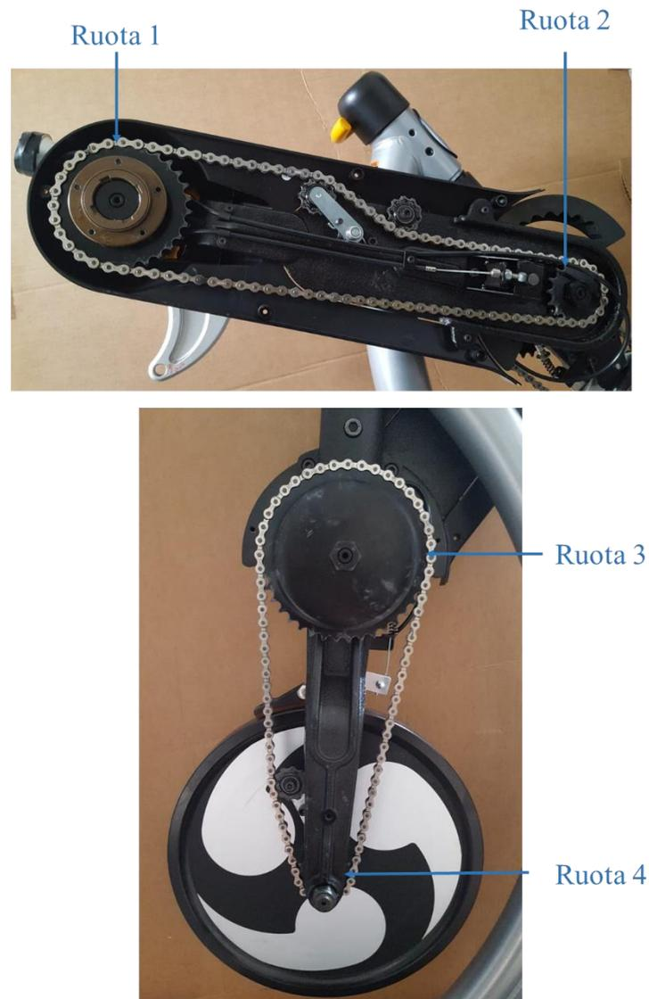
Figura 6.4- Ruote dentate del Krankcycle che trasmettono il moto
