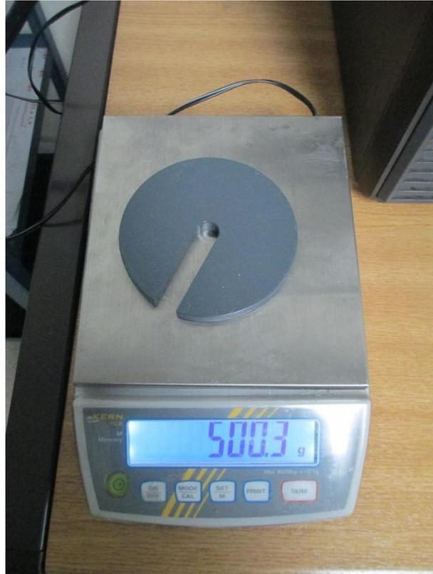
Figura 3.18- Bilancia digitale per pesatura
