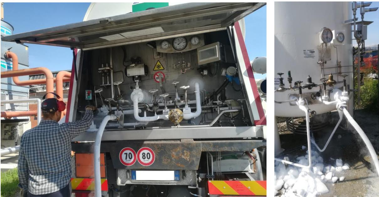
**Figura 8.** Autocisterna con operatore intento al riempimento del serbatoio criogenico (Rivoli)
