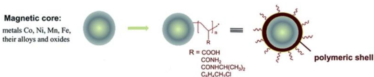
Figura 2.8 Nanoparticella magnetica rivestita con polimero [23]
