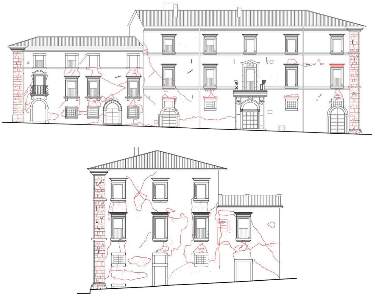
*Fig. 3.5: rilievo del quadro fessurativo post sisma delle due facciate principali del Palazzo Pietropaoli di via Antonelli e via Sallustio.*
