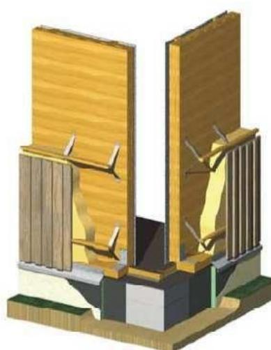
Figura 66 Montaggio di un elemento preassemblato (sinistra) e fissaggio di elementi di isolamento e di facciata (destra).
