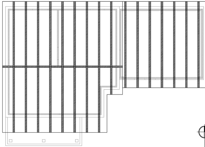
Figura 96 Pianta copertura in travi di legno lamellare
