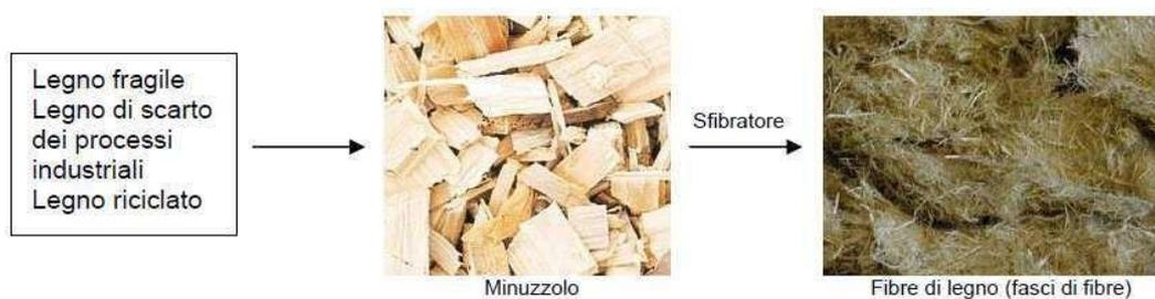
Figura 34 Fasi produttive delle fibre di legno.
