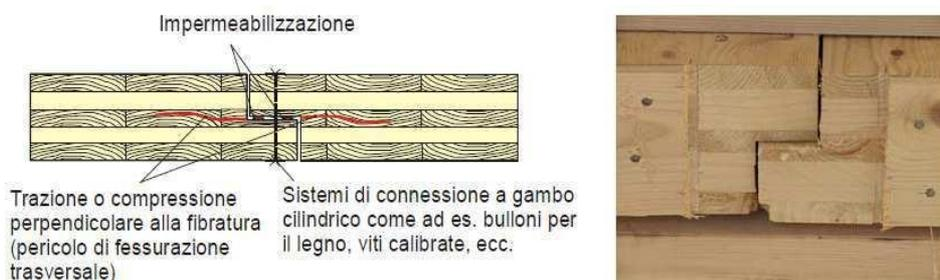
Disponendo coprigiunti (ad esempio di legno compensato, pannelli a tre strati, Kerto), incassati nelle parti superiore ed inferiore degli elementi di legno compensato di tavole, può essere realizzata una connessione rigida a flessione. È possibile, inoltre, incollare questi elementi (la pressione necessaria è ottenuta con bulloni o chiodi); questa operazione di incollaggio è tuttavia da evitare in cantiere.
