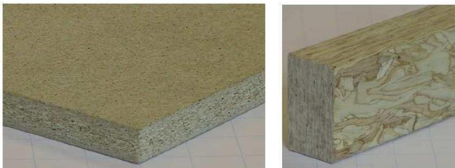
Figura 41 Pannello piano pressato incollato con resine sintetiche (sinistra) e pannello di trucioli a striatura (destra).
