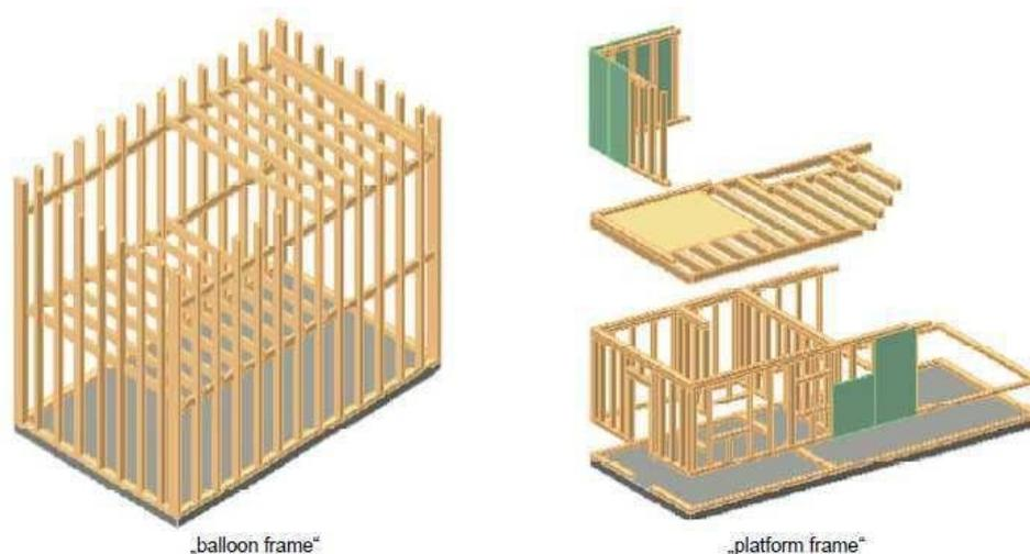
Figura 81 Sistemi costruttivi per strutture ad intelaiatura di legno.
