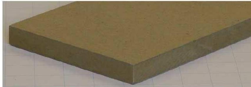
Figura 39 Pannello di fibra di legno a media densità (MDF).
