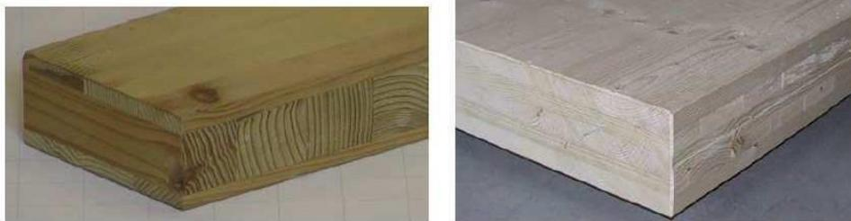
*Figura 47 Pannelli di legno massiccio a tre strati (sinistra) e pannello di legno compensato di tavole a cinque strati (destra).*
