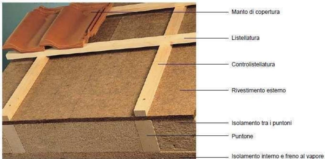
Figura 37 Struttura di una copertura con isolamento tra gli elementi dell'orditura;
