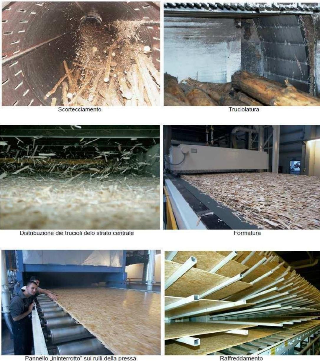
Figura 43 Alcune fasi di un ciclo produttivo continuo per la produzione di pannelli OSB.
