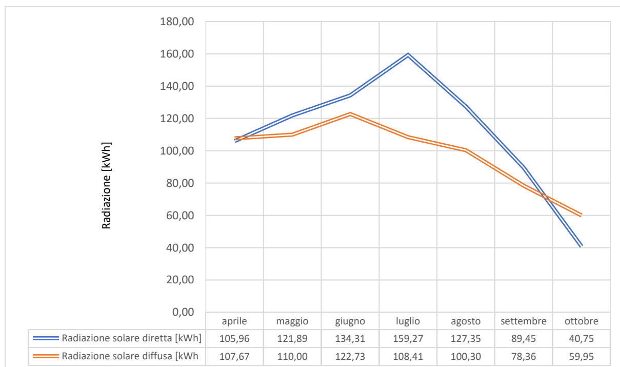
Grafico 5.4.2.4 Design Builder, Simulazione estiva _dati del luogo – radiazione solare
