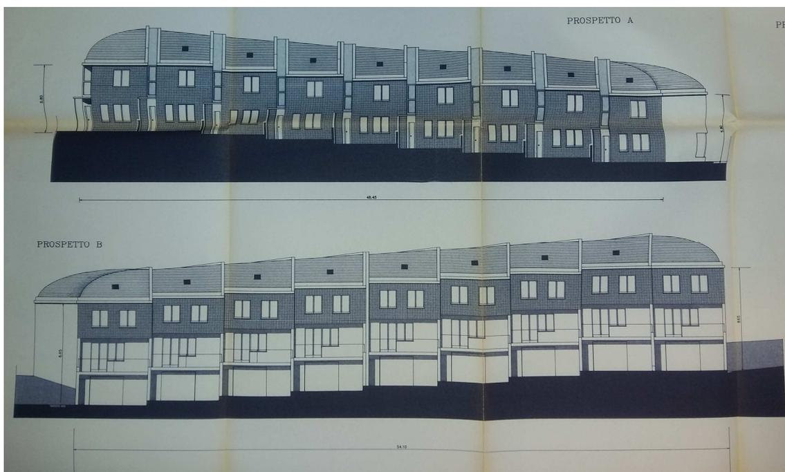
Fig. 3.29 Prospetti frontali di unità abitative a schiera, caratteristiche della tipologia.
