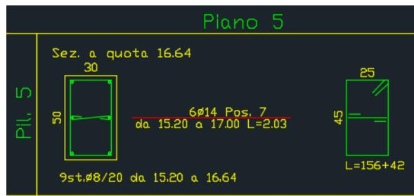
Fig. 4.79 Armatura esistente piano 5.
