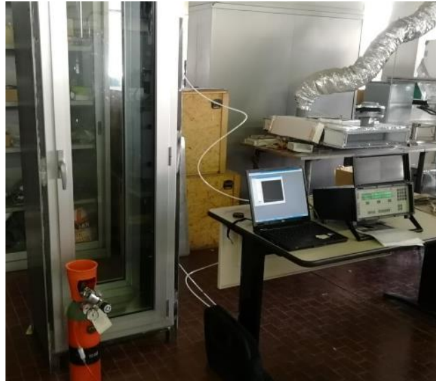
FIGURA 17_ APPARECCHIATURE PER LA MISURAZIONE DELL'INERTE SF6
