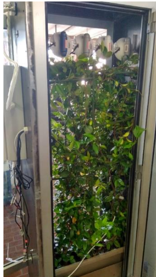
FIGURA 19_ PROTOTIPO COMPLETO DI SENSORI, PER LA MISURAZIONE DEGLI INQUINANTI, E DELLA PIANTA SOGGETTO DI STUDIO.
