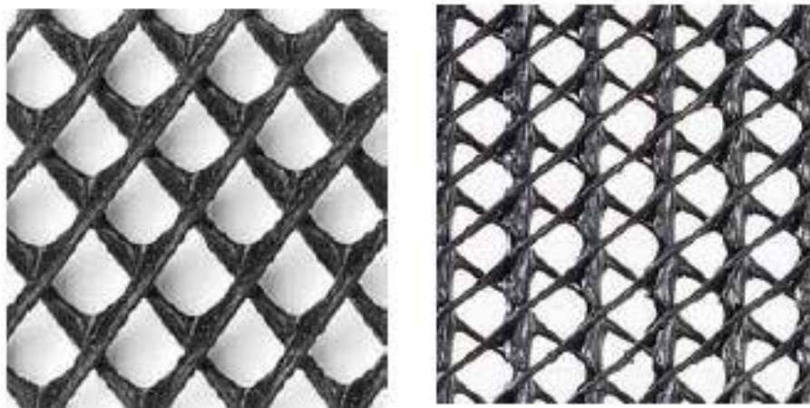
Figura 15 Georete bidimensionale (sinistra) e georete tridimensionale (destra)
