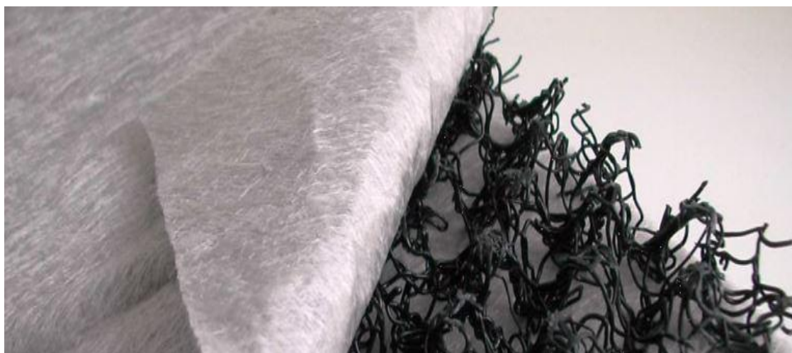
Figura 20 Geocomposito realizzato con un nucleo in geostuoia ad alto indice di vuoti in monofilamenti in PP accoppiato ad uno/due filtri/membrana impermeabile
