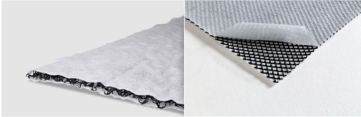
Figura 21 Geocomposito drenante realizzato con filamenti estrusi accoppiato con due strati di geotessile nontessuto (sinistra). Geocomposito ottenuto con l'accoppiamento di una georete con due geotessili (destra)
