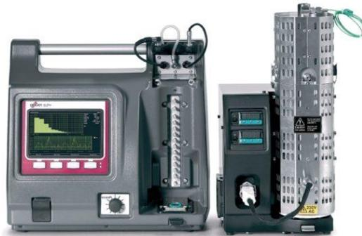
Figura 7.8 - Impattatore elettrico a bassa pressione ELPI, modello Dekati HT ELPI
