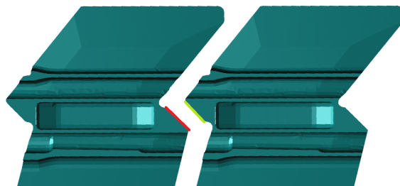
Figura 1.7: Tip-shroud e superfici coinvolte nel contatto.
