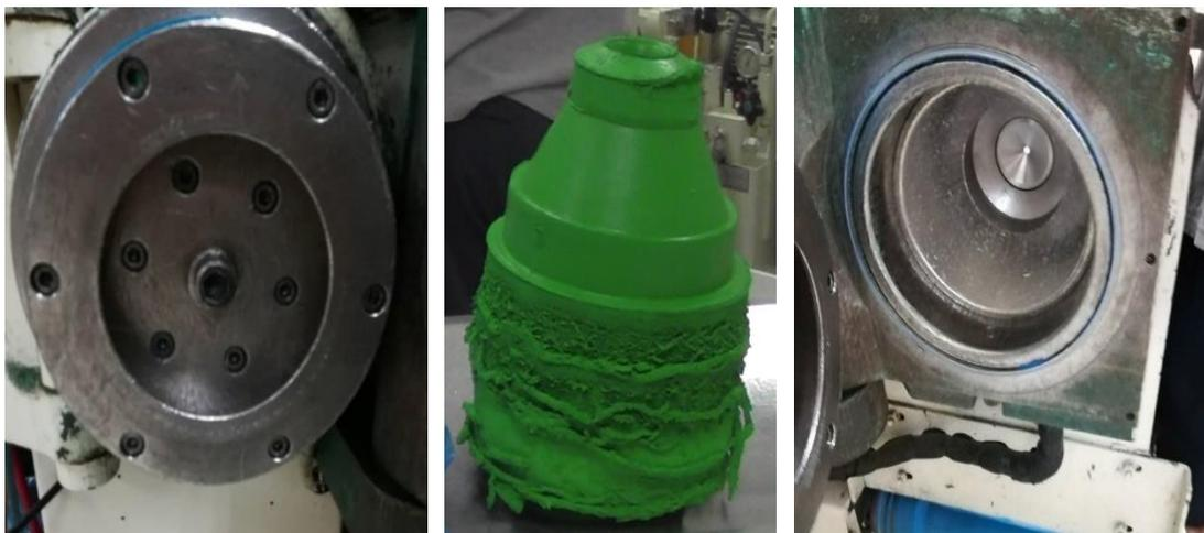
Figura 26 - Da sinistra: la parte finale del pistone (*dummy block*), di seguito la *head of material* che rimane dentro la macchina e la parte finale contenente la matrice
