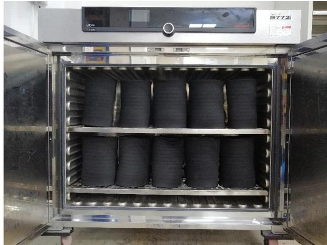
Figura 36 - Posizionamento dei rolli di materiale all'interno del forno industriale
