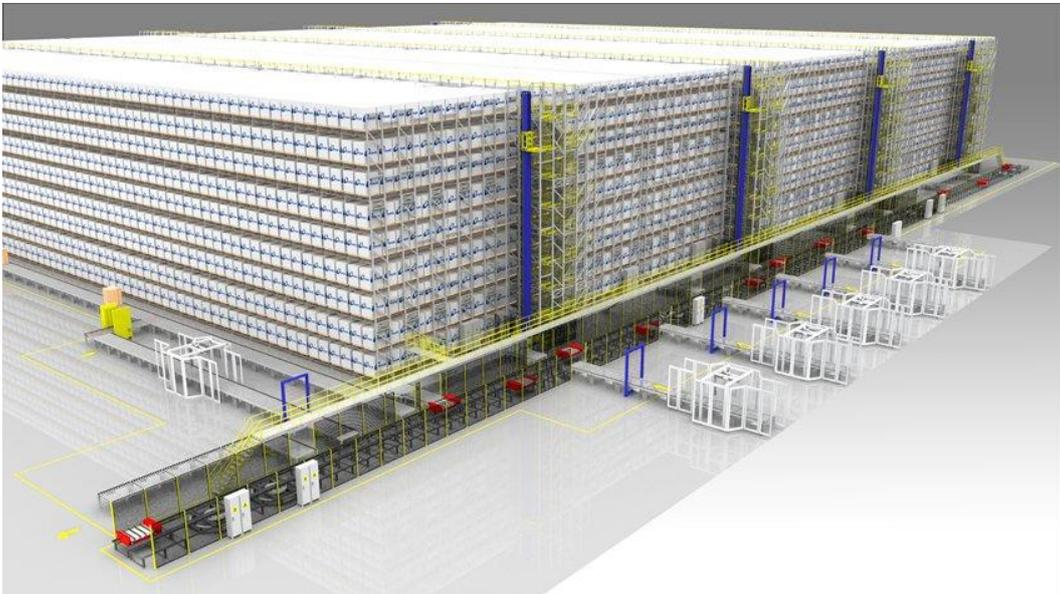
Figura 16 - Magazzino intensivo con traslo elevatore e baia di interfaccia<sup>34</sup>
