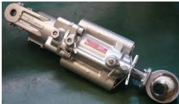
*Figura 6. Un martinetto idraulico per la movimentazione flap*
