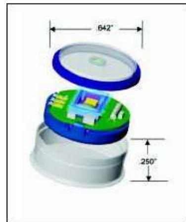
**Fig. 5. 6:** struttura degli Ibutton
