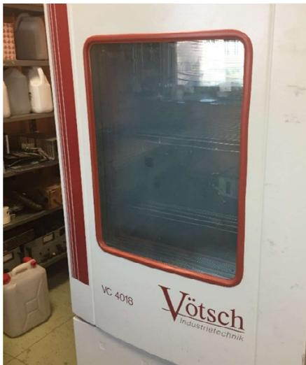
Fig. 5. 92: camera per test climatici
