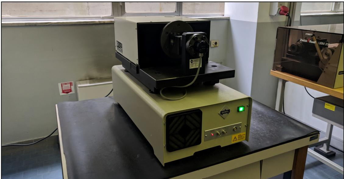
**Fig. 4.16** RUMUL Cracktronic 8204
