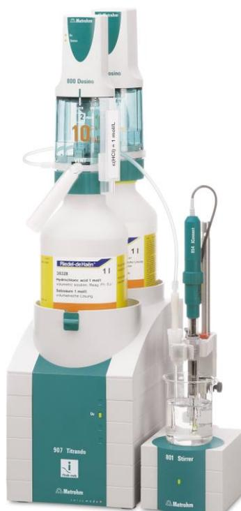
Figure 4.6: Front 907 Titrando.<sup>40</sup>
