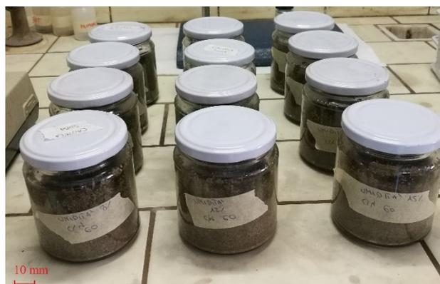
**Figura 2.2.3** Microcosmi con 200 g di terreno contaminato con il 7% in peso di gasolio al variare del contenuto di umidità (8%-12%-15%) e del rapporto carbonio-azoto (60-120-180-300)
