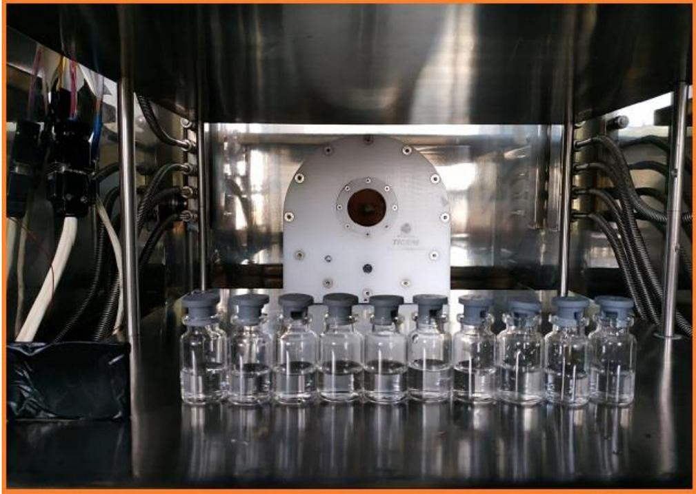
**Figura 2.3:** Posizionamento della termocamera IR all'interno dell'autoclave.
