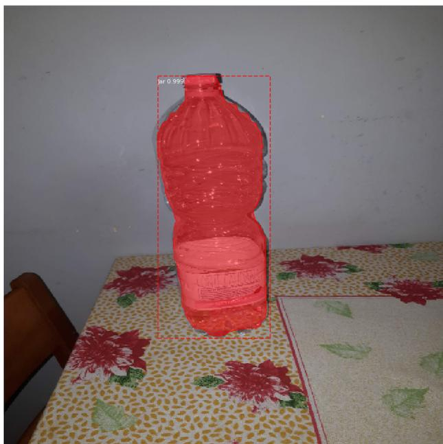
Figura 5.18: Risultato della predizione di Mask R-CNN su un'immagine contenente una singola istanza. La rete ha individuato un oggetto di classe *Bottle*.
