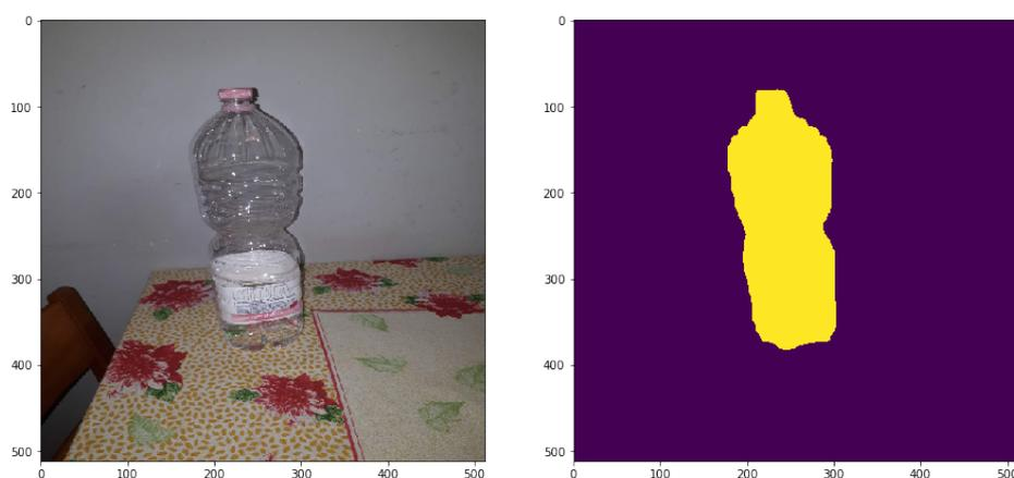
Figura 5.19: La figura mostra, a sinistra, l'immagine originale e, a destra, la maschera binaria associata all'istanza predetta da Mask R-CNN (*Trivial mask*).
