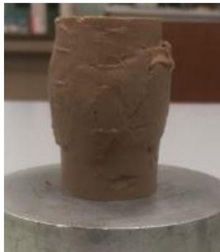
Figura 129. Comportamento a botte in fase di rottura del campione CB-5-0 (20KPa).
