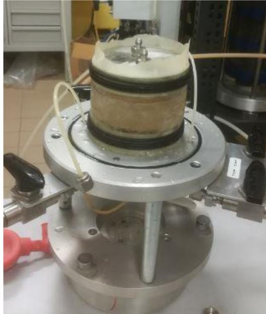
*Figura 91. Montaggio permeametro a pareti flessibili (laboratorio di geotecnica, DISEG, Polito).*
