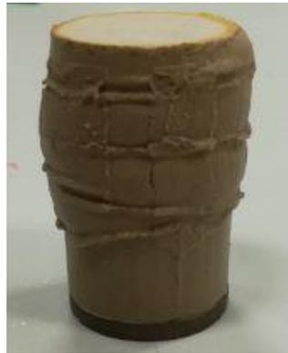
*Figura 140. Rottura del campione CB-4-0 (20KPa).*
