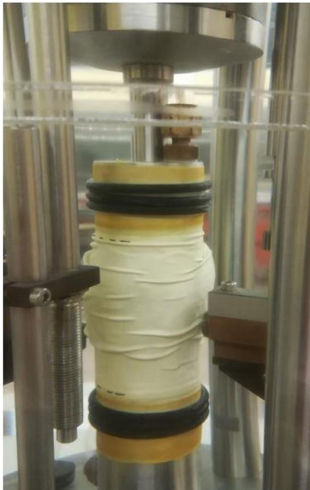
*Figura 79. Campione dopo la fase di rottura*
