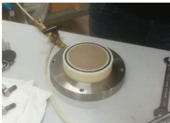
Figura 89. Allocazione dell'anello contenente il campione nella sede di prova (laboratorio di geotecnica, DISEG, Polito).
