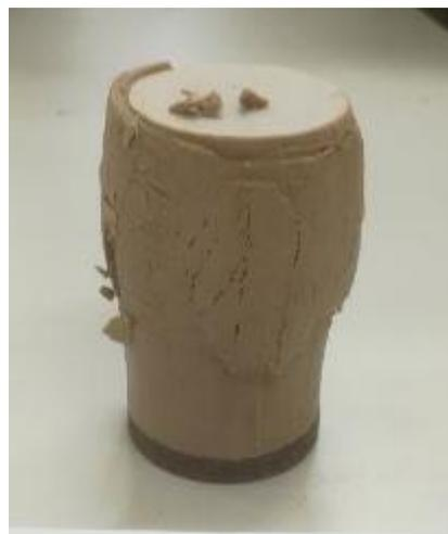
Figura 130. Comportamento a botte in fase di rottura del campione CB-5-0 (100KPa).
