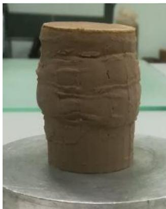
*Figura 141. Rottura del campione CB-4-0 (100KPa).*
