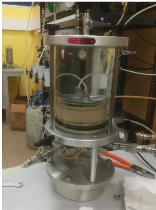
*Figura 92. Montaggio ultimato di un permeametro a pareti flessibili (laboratorio di geotecnica, DISEG, Polito).*
