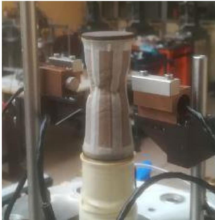
*Figura 154. Prova sul campione CB-6-0 (300 KPa) fallita.*
