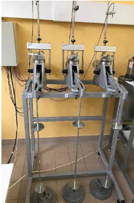
Figura 85. Apparecchiatura edometrica (laboratorio di geotecnica, DISEG, Polito).
