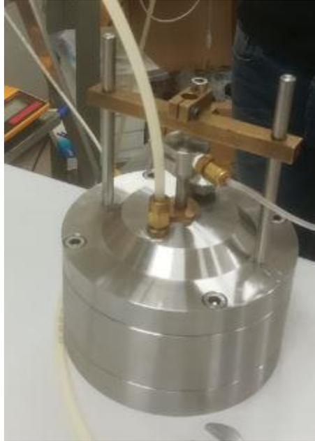
*Figura 90. Chiusura dell'attrezzatura di prova (laboratorio di geotecnica, DISEG, Polito).*
