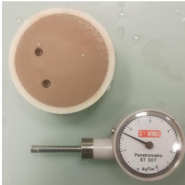
Figura 110. Prova penetrometrica.
