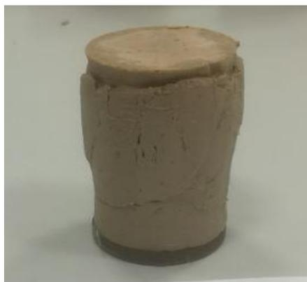
*Figura 131. Rottura per taglio del campione CB-5-0 (300KPa).*
