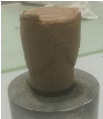
*Figura 152. Rottura del campione CB-6-0 100KPa).*
