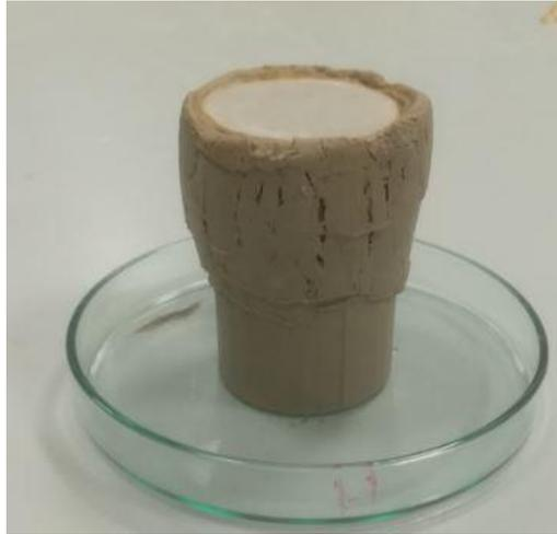
*Figura 151. Rottura del campione CB-6-0 (20KPa).*
