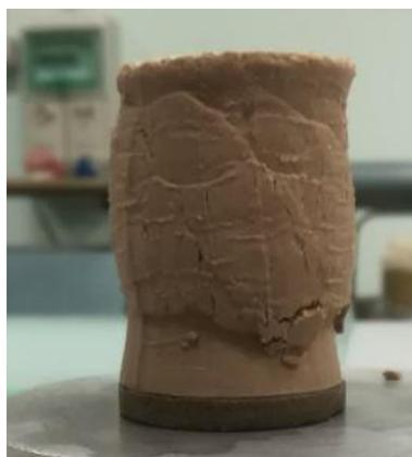
*Figura 142. Rottura del campione CB-4-0 (300KPa).*
