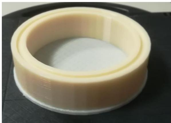
*Figura 101. Cassaforma per provino per la prova di conducibilità.*
