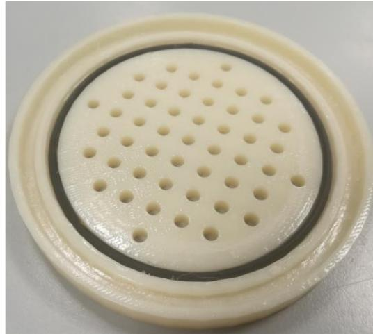
Figura 102. Elemento di fondo del cassero per la prova di conducibilità.
