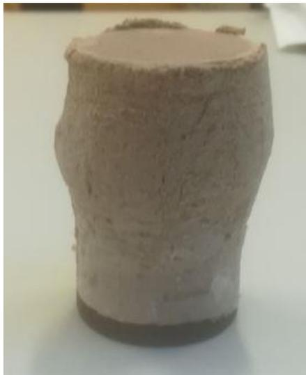
*Figura 153. Rottura del campione CB-6-0 300KPa).*
