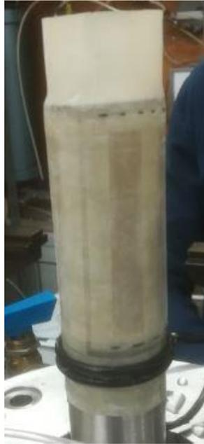
*Figura 77. Montaggio membrana in lattice*
