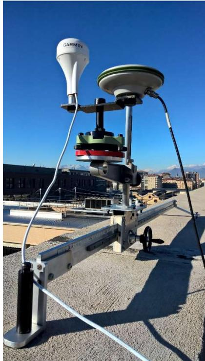
*Figura 64– Slitta micrometrica con le due antenne – geodetica e singola frequenza – collegate al ricevitore u-blox*
