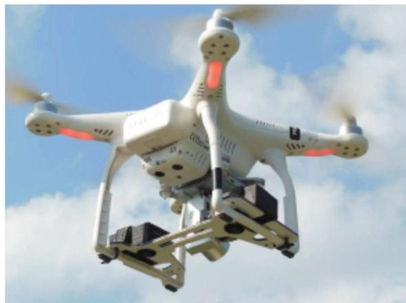
Figura 26 - Esempio di un drone equipaggiato con un laser scanner [17]
