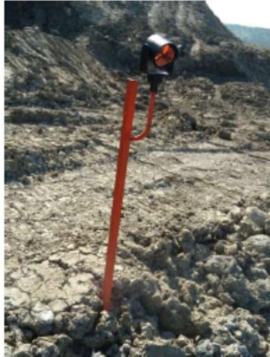
*Figura 15 - Esempio di un prisma installato nel corpo frana [8]*
