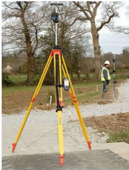
Figura 44 - Esempio di ricevitore geodetico a doppia frequenza per il posizionamento RTK [23]
