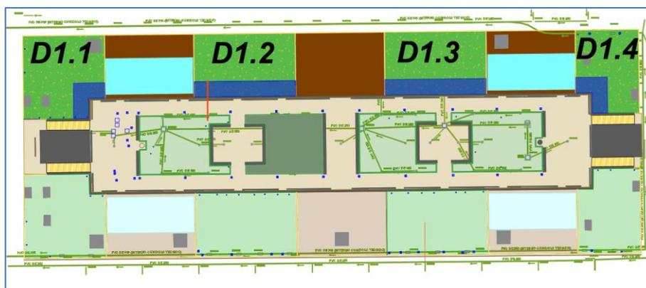
**Figura 9.8** L'area blu rappresenta la collocazione dei possibili sistemi di troppo pieno mentre la tubazione arancione mostra la collocazione adottata per la valutazione delle portate smaltite dal sistema
