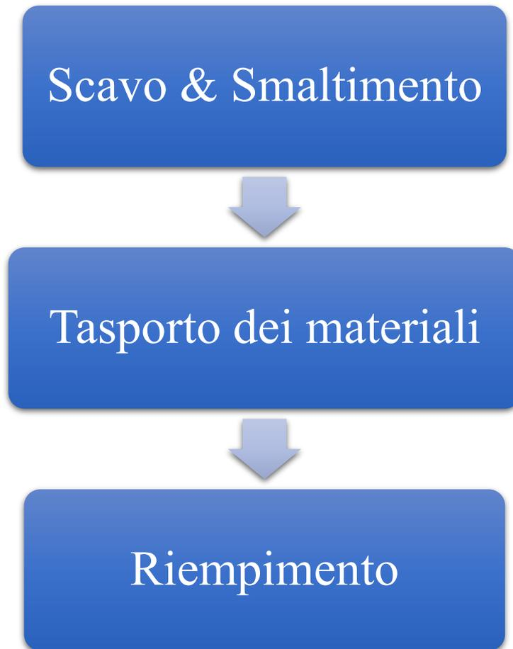
**Scavo** – Lo scavo per la realizzazione di ciascuna vasca deve prevedere lo sbancamento, ovvero la rimozione del primo strato di terreno vegetale che un approfondimento che è variabile a seconda della soluzione che si vuole adottare. Questa lavorazione avviene mediante l’ausilio di una pala meccanica il cui costo al m<sup>3</sup>.
