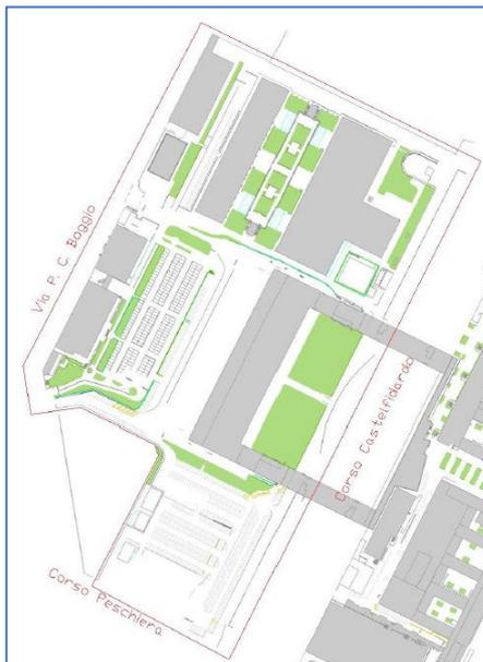
Figura 3.4 Planimetria della Cittadella del Politecnico di Torino, con indicazioni sui percorsi effettuati dalle acque meteoriche. Si riportano in grigio gli edifici e in verde le aree verdi
