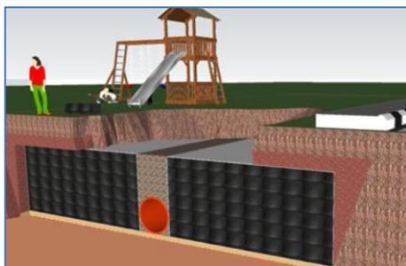
**Figura 6.8** Moduli cellulari SWM e rispettivo metodo di impiego
