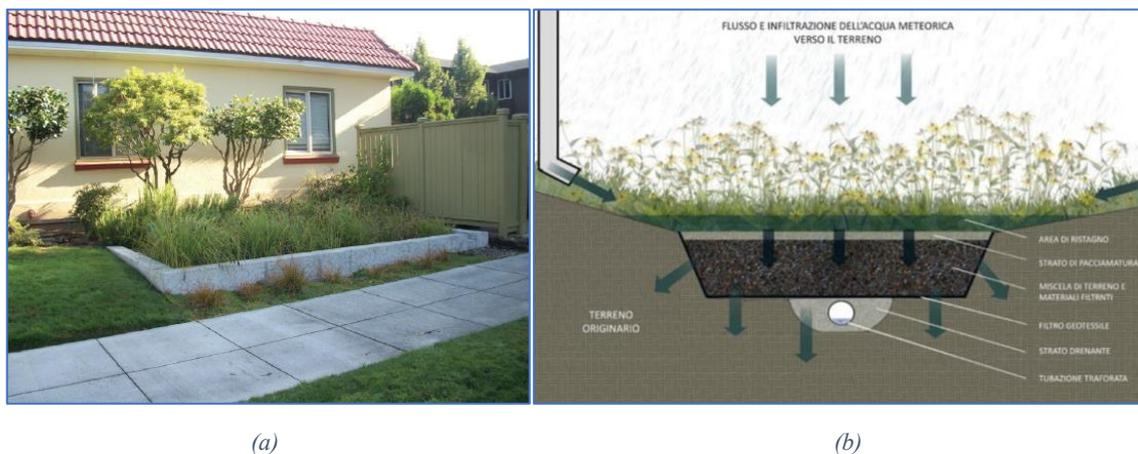
Figura 4.6 Sezione di un Rain garden. Questi sono tipicamente sistemi che garantiscono i propri benefici ad una singola proprietà. Sono meno ingegnerizzati rispetto ai componenti di un sistema di bioritenzione completo.
