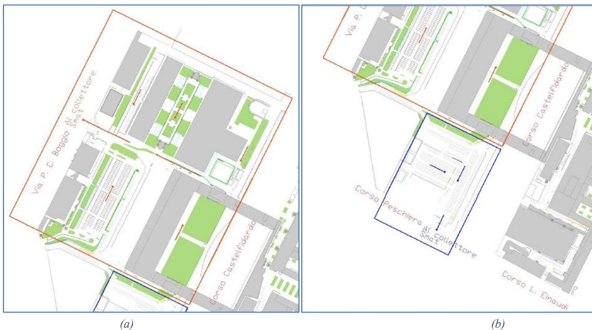
Figura 3.6 Planimetria della Cittadella del Politecnico di Torino. Si riportano in grigio gli edifici e in verde le aree verdi (a) Zona delimitata dalla linea arancione. Le frecce arancioni indicano le direzioni dei percorsi effettuati dalle acque meteoriche (b) Zona delimitata dalla linea blu. Le frecce blu indicano le direzioni dei percorsi effettuati dalle acque meteoriche
