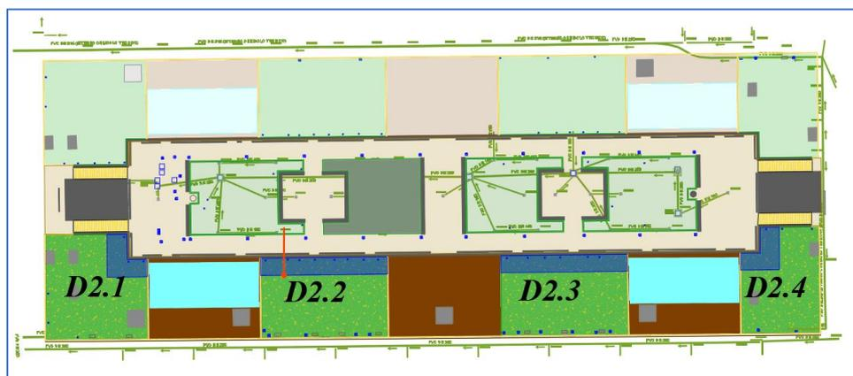
**Figura 9.9** L'area blu rappresenta la collocazione dei possibili sistemi di troppo pieno mentre la tubazione arancione mostra la collocazione adottata per la valutazione delle portate smaltite dal sistema
