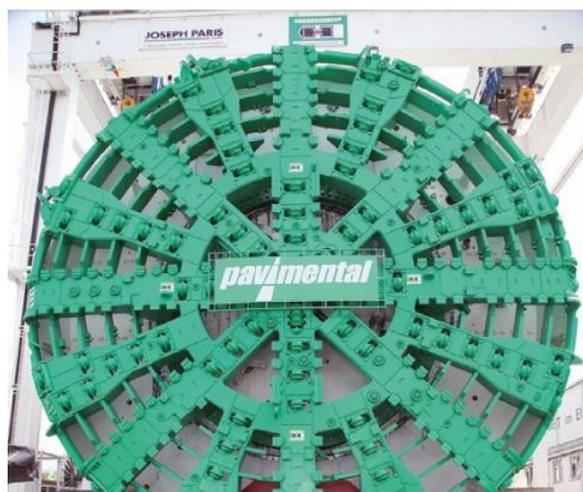
*Figura 5.1: Testa di scavo della TBM EPB impiegata per lo scavo della galleria Santa Lucia*
