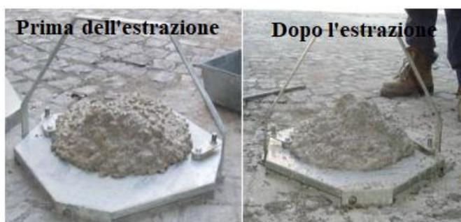
Figura 4.7: Prove di slump prima e dopo l'estrazione del materiale nella prova MML-B
