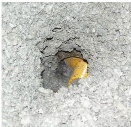
Figura 4.6: Cavità nel materiale creata dalla rotazione della coclea
