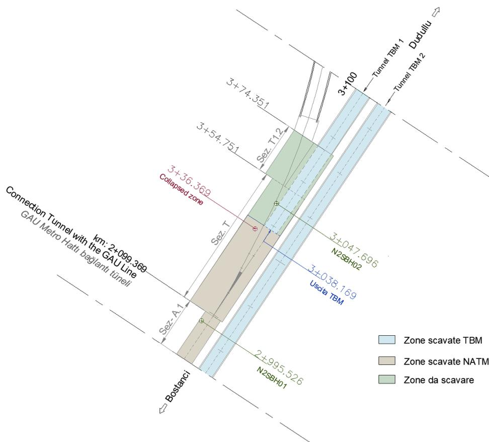
*Figura 2.14* Schema generale della situazione post-crollo
