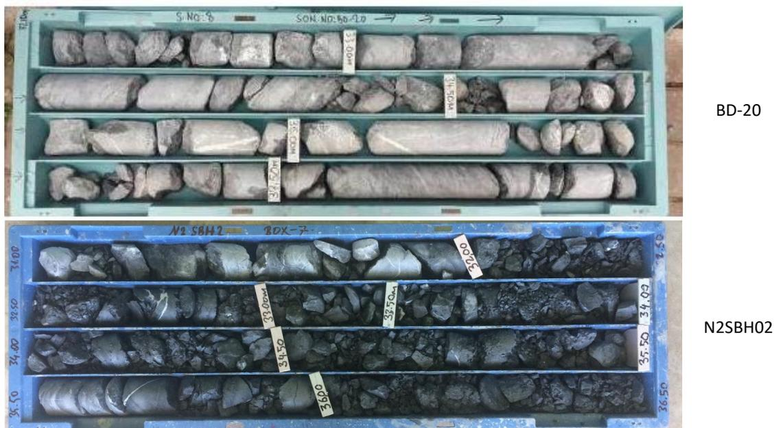
Figura 2.12 Confronto tra il materiale alla profondità di interesse per le due perforazioni (cortesia di Geodata)
