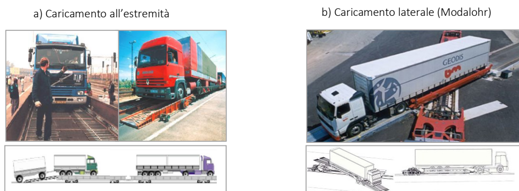
Figura 1.18 Modalità di caricamento del veicolo nel trasporto combinato accompagnato. Fonti: (De Oña Lopez, 2017) e (Dalla Chiara, 2015).
