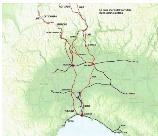
Figura 2.6 Corridoio Reno-Alpi in Italia. GBT: Tunnel di Base del Gottardo; CBT: Tunnel di Base del Ceneri; LBT: Tunnel di Base del Lötschberg; 3V: Tunnel del Terzo Valico. Stazioni di confine: Chiasso, Luino, Domodossola. Fonte (Sito Web intermodale24-rail, 2018)
