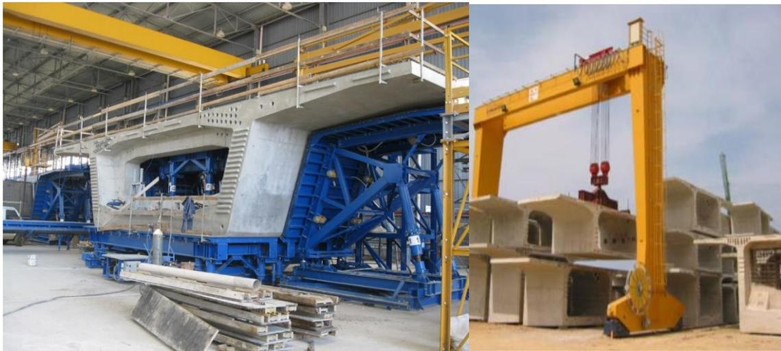
*Fig 2.3-1 Prefabbricazione in stabilimento*
