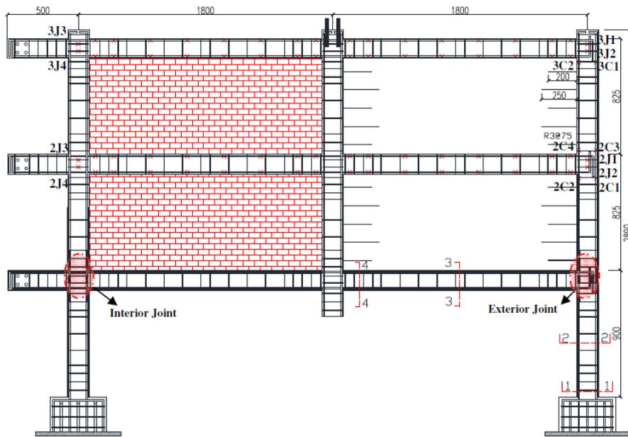
Figura 3.23: Dettaglio costruttivo del telaio non tamponato con dettagli sismici
