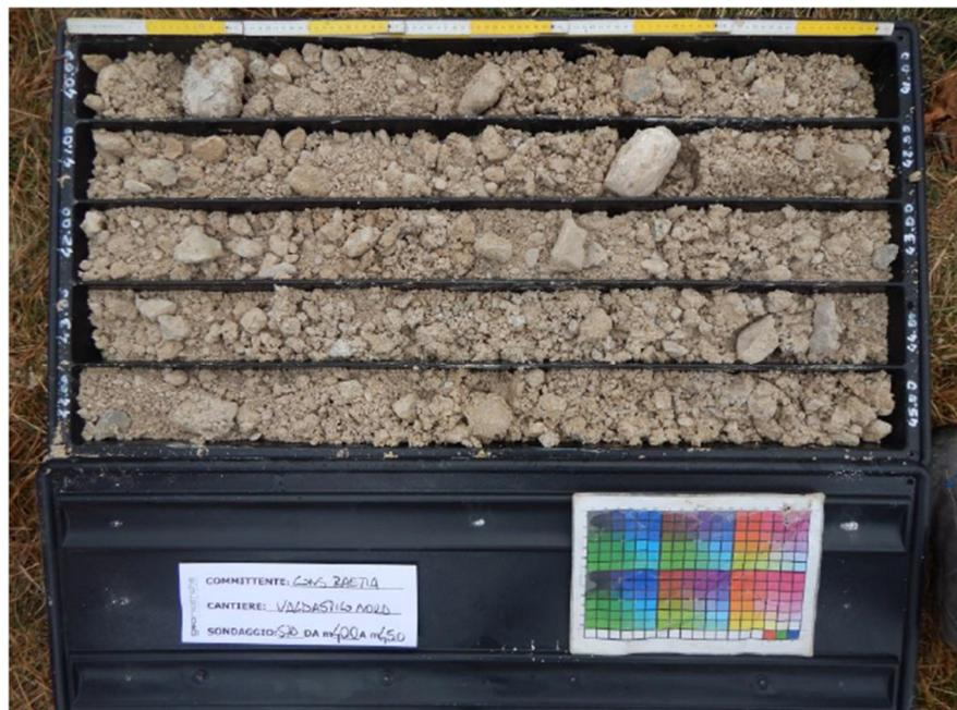
Figura 3.1- Sondaggio S7D – imbocco sud galleria
