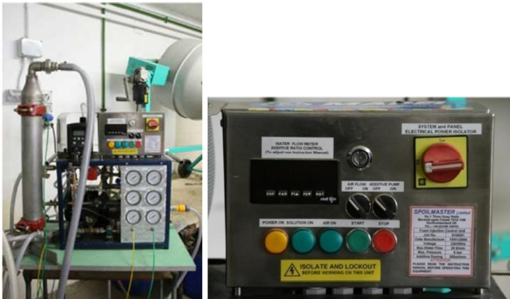
**Figura 4.1** - Generatore di schiuma utilizzato presso il laboratorio TUSC del DIATI. Unità di generazione di schiuma (sinistra). Pannello di controllo dei parametri di generazione della schiuma (destra)
