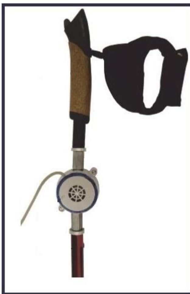
*Figura 3.3-Trasduttore di forza integrato nel bastoncino [47]*
