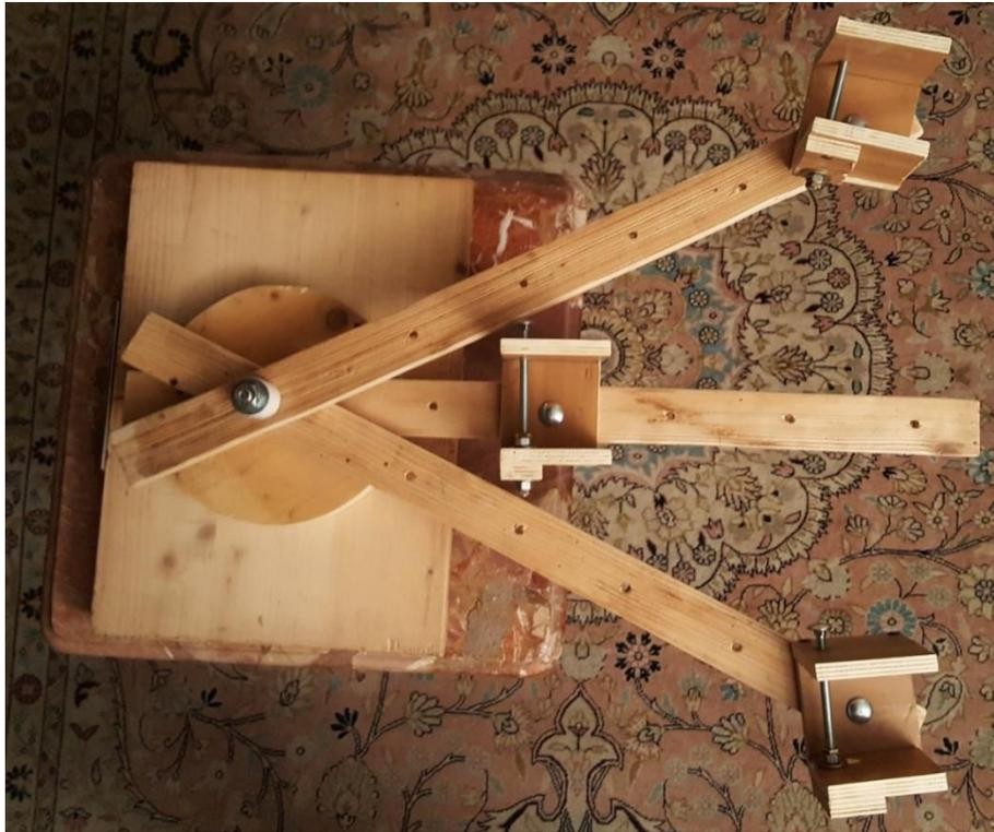
**Figura 49 – Primo setup sperimentale: base di sostegno per le fotocamere**
