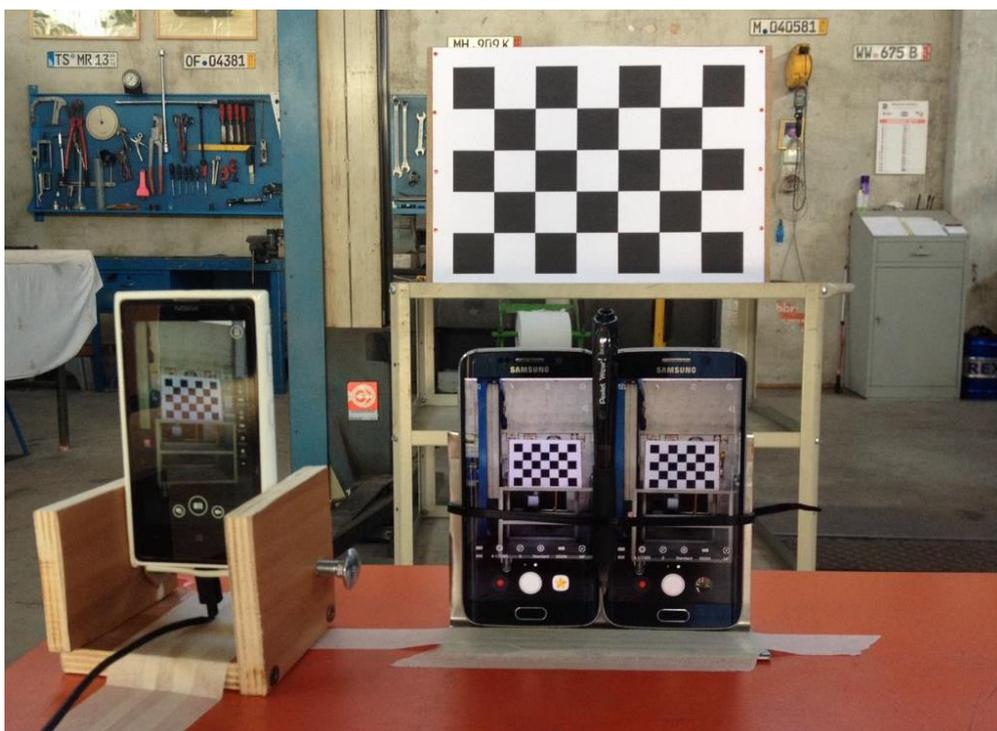
Figura 77 – Quarto setup sperimentale, fase di calibrazione, camere Samsung Samsung e Nokia
