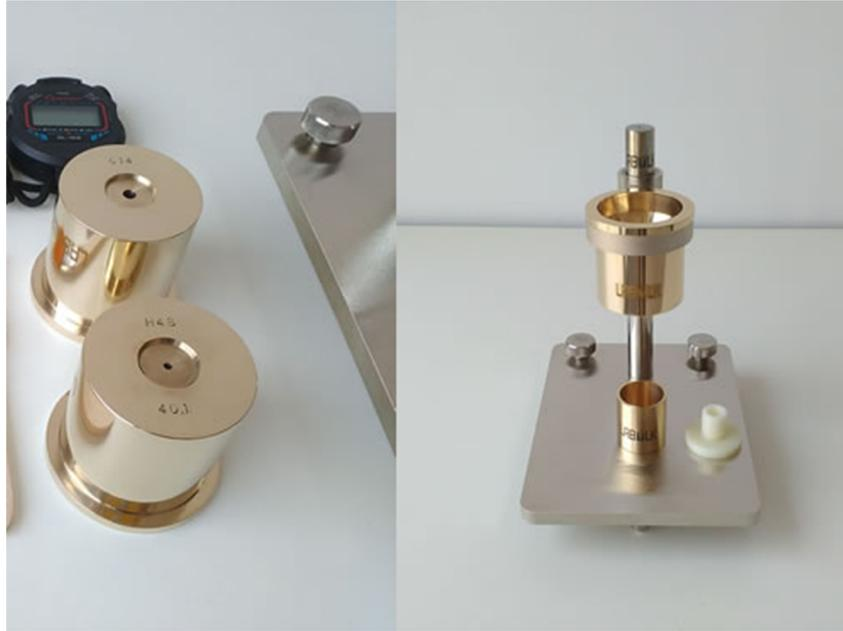
Figura 27 - Strumentazione per il test di scorrevolezza
