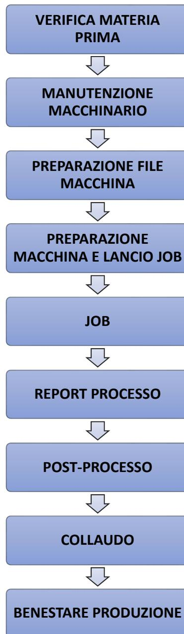
Figura 40 – Schema di qualifica di processo per tecnologia L-PBF
