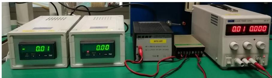
Figura 6.8 Condizionatori trasduttori, amplificatore, scheda di controllo valvola, generatore di tensione
