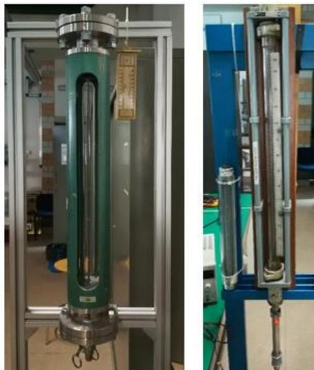
*Figura 6.9 Flussimetro ASA e flussimetro ROTA*
