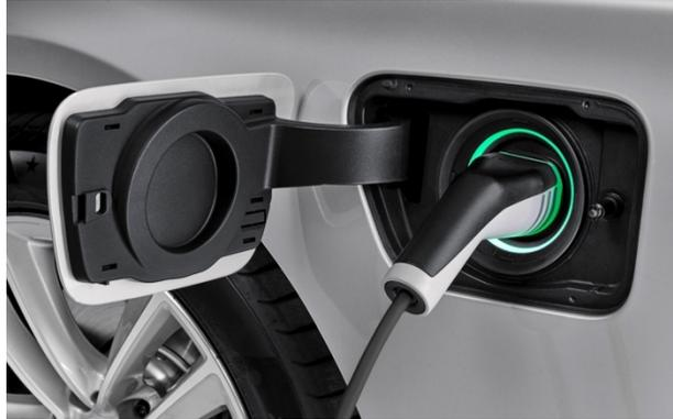
*Figura 30 – Dettaglio ricarica ibrido Plug-In nel caso di un'autovettura*
