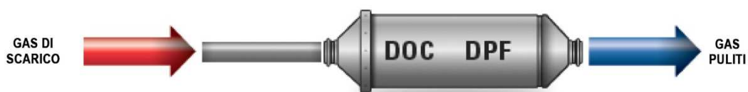
Figura 7: Schema di un tipico sistema di post-trattamento negli Euro 5.
