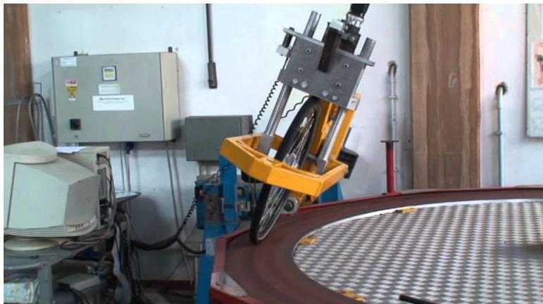
*Figura 14 - Macchina prova pneumatici a disco dell'Università di Padova.*
