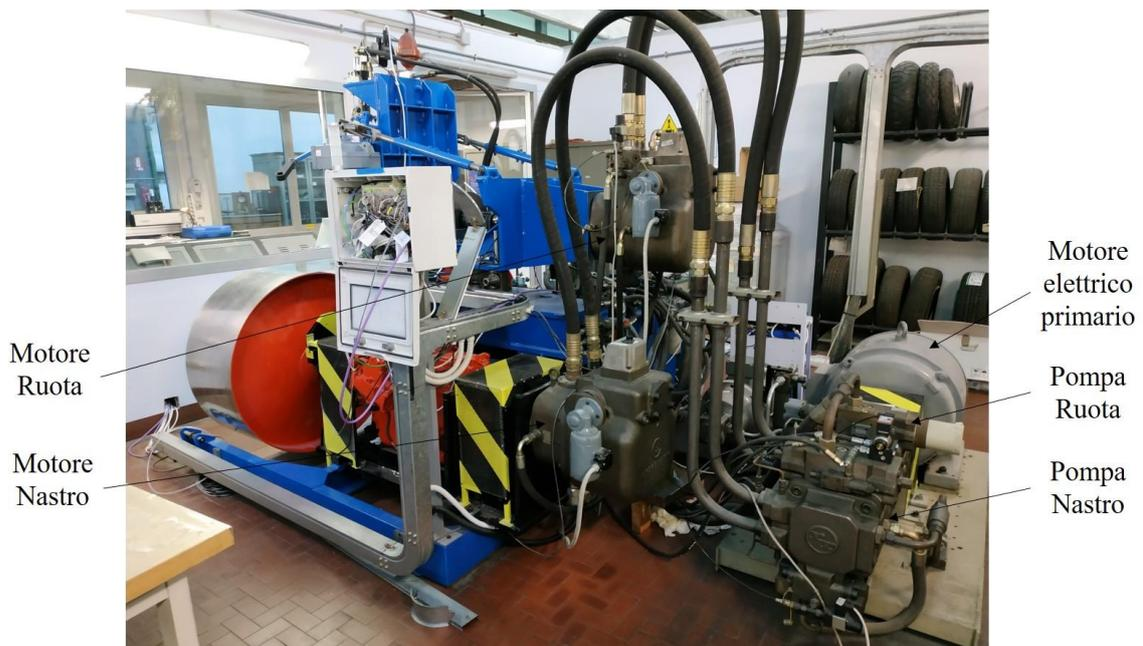
Figura 18 - Vista posteriore della MPP.
