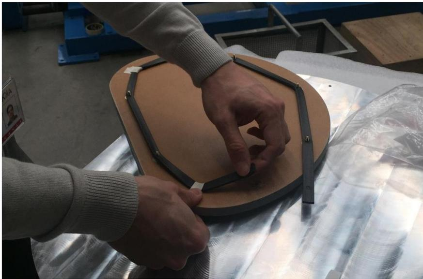
**Figura 3.6.6 Applicazione della guarnizione**
