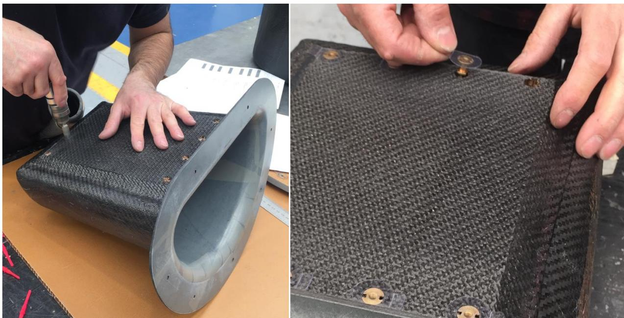
**Figura 3.5.15: Foratura e inserimento degli inserti**
