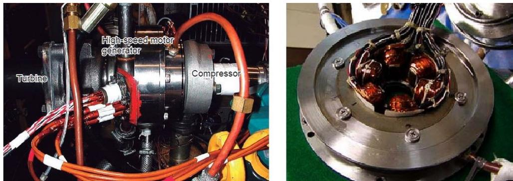
Figura 1.10: Condizioni di test del turbo ibrido e aspetto dello statore della EM
