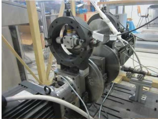
Figura 2.7: Roller rig a sala singola per valutazione della riadesione [79]
