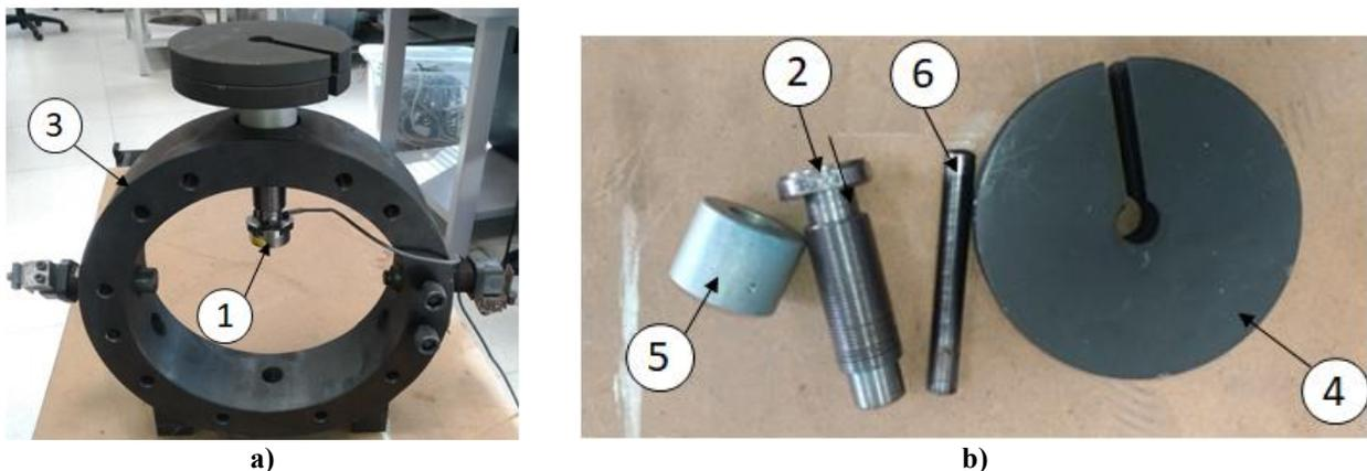
**Figura 3.22: Apparato sperimentale per la calibrazione delle celle a bottone: assieme (a) e componenti (b)**
