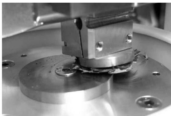
Figura 2.1: Macchina *pin-on-disk* utilizzata da Olofsson et al. [39]
