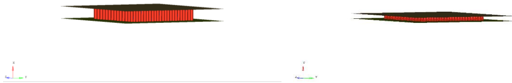
Figura 35: Compressione statica blocco posteriore a t=0 ms (sinistra) e a t=25 ms (destra).
