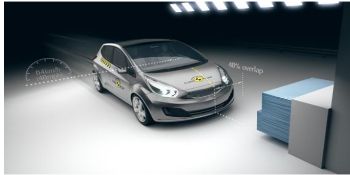
Figura 6: Test frontale disassato [14].
