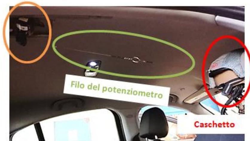
Figura 5-6: potenziometro fissato al caschetto
