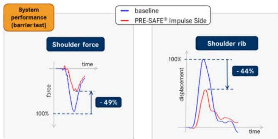
Figura 4-11: efficacia di Pre-Safe Impulse Side nel test barriera [32]
