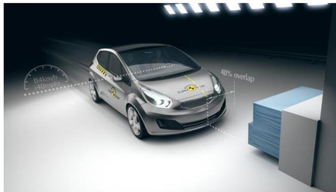
Figura 3-2: test frontale disassato [15]
