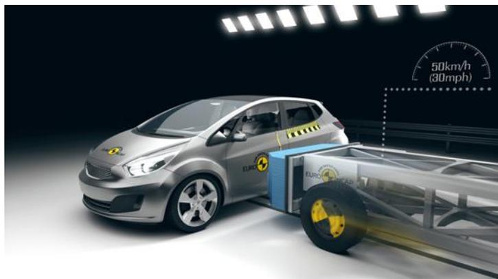
Figura 3-4: test di impatto laterale [15]
