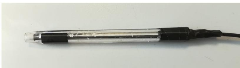
Figura 5.2.3: La fibra ottica nel suo alloggiamento.
