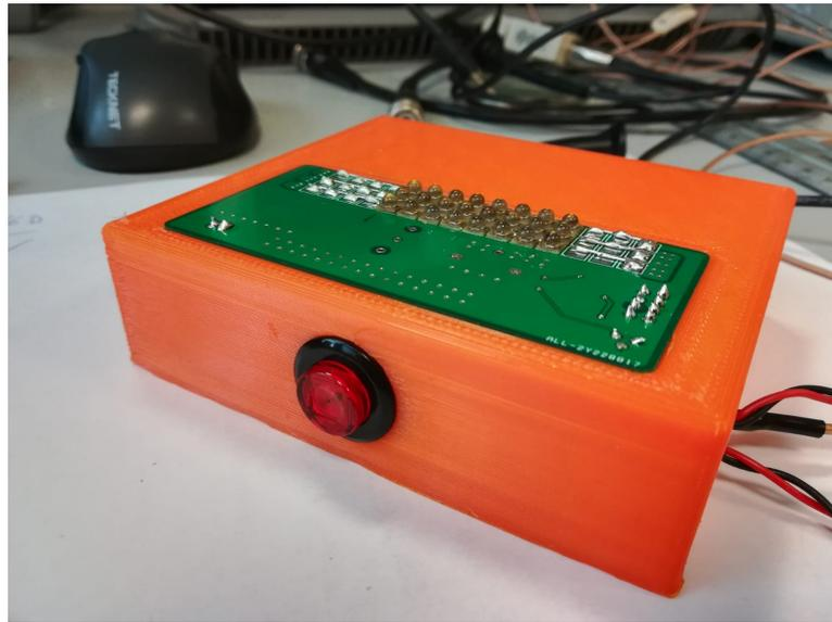
Figura 4.6.2: Il pcb installato nel suo alloggiamento..
