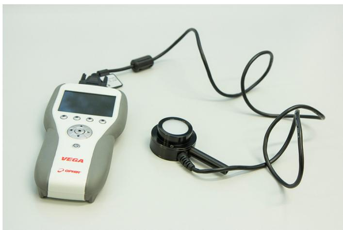
Figura 5.2.1: Il power meter Ophir Vega, completo di fotodiodo separato.
