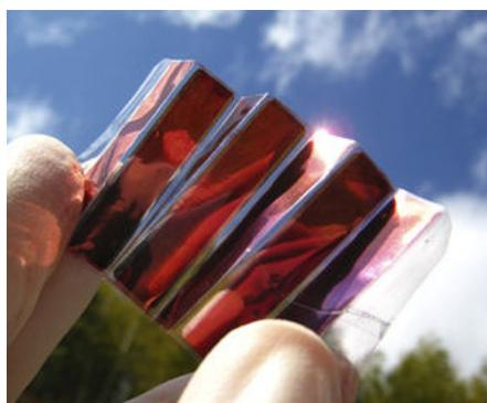
Figura 1.5: Fotovoltaico organico: cella realizzata in nanocellulosa
