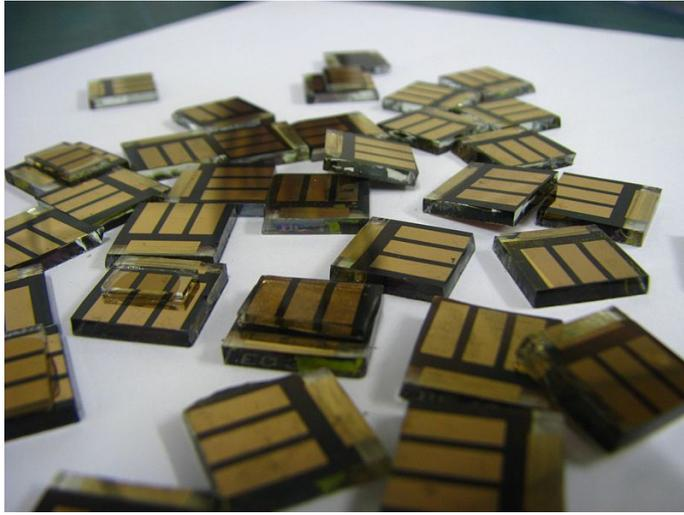
Figura 1.6: Celle in stagno e perovskite
