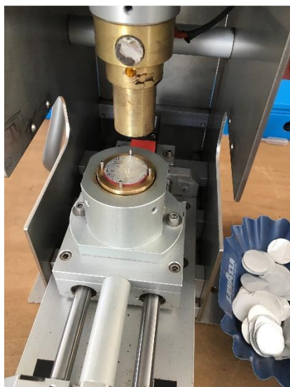
Figura 24 - Strumento per termosaldatura lid su capsula.
