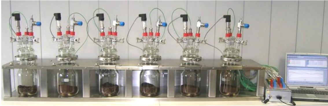
Figura 49 - Strumentazione Probat per valutazione degassaggio caffè tostato e macinato.
