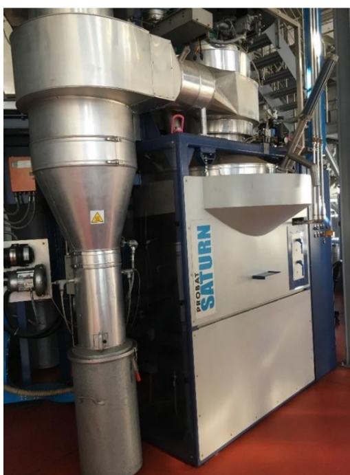
Figura 19 - Tostatrice sita presso impianto pilota.
