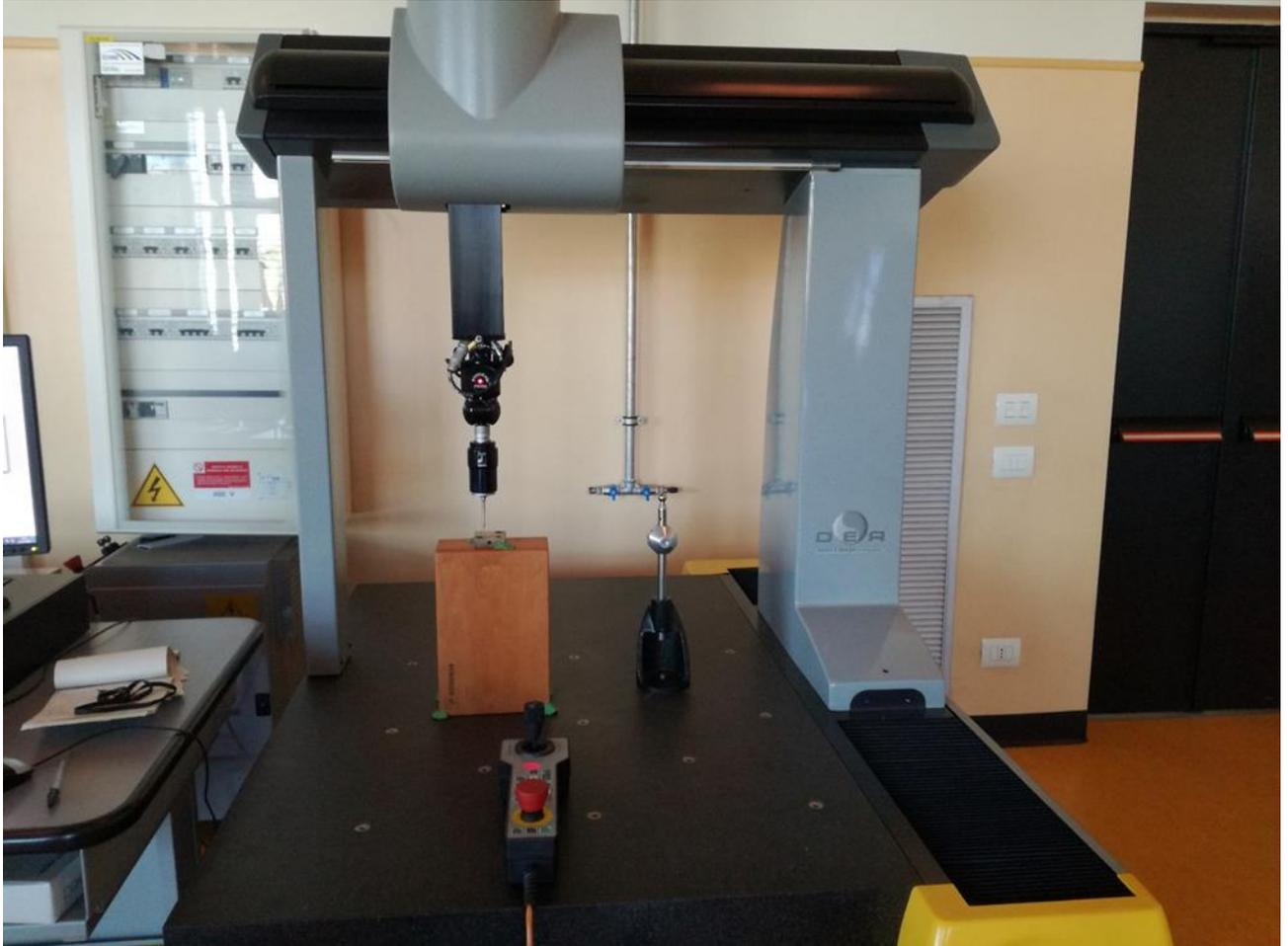
*Figura 35. Macchina a misura coordinate (CMM)*
