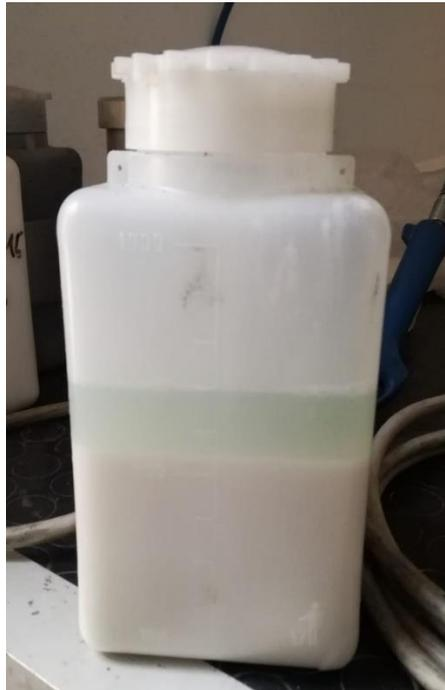
*Figura 28. Soluzione di acqua, sapone con abrasivo polvere di corindone*
