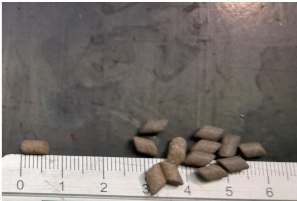
Figura 75. Abrasivo ceramico utilizzato nei Test 1,2,3
