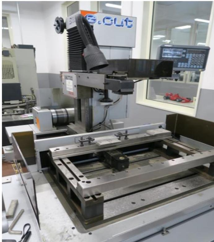
*Figura 62. Macchina per il processo di taglio Wire EDM*
