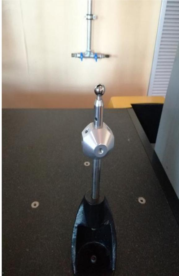
*Figura 36. Sfera di riferimento per la calibrazione del tastatore*
