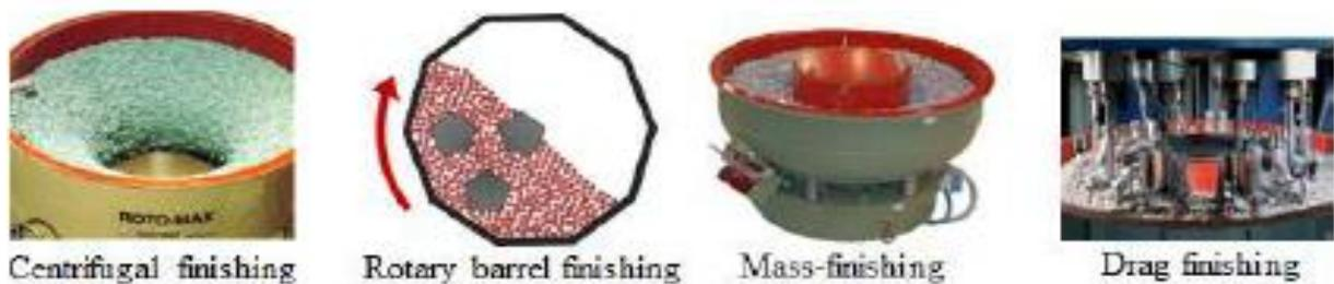
Figura 26. Tipi diversi di burattatura rispetto al fissaggio del pezzo [70]
