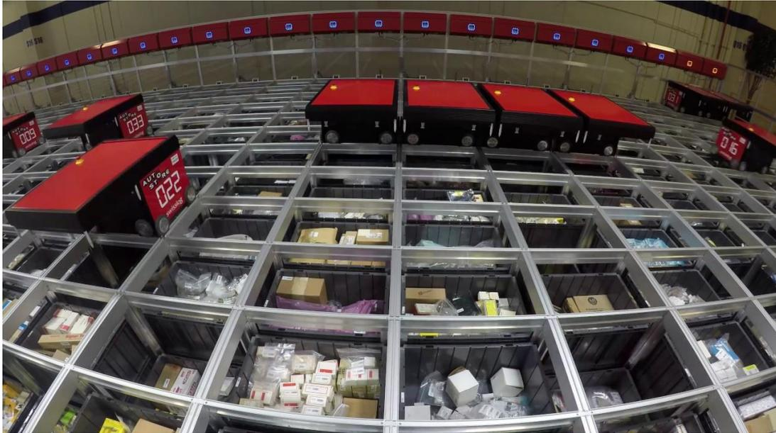
Figura 1.3: Magazzino automatizzato e modulare Swisslog per Radwell International [3].
