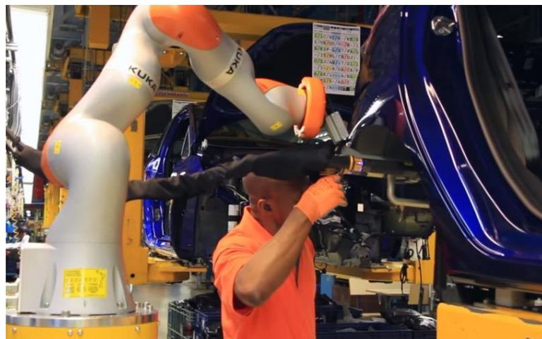
Figura 1.8: Cobot realizzato da KUKA Roboter GmbH, utilizzato per installare ammortizzatori su Ford Fiesta [10].
