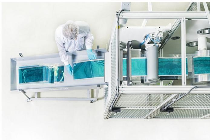
Figure 3.17 linea di produzione di un prodotto OPV (fonte: Heliatek)
