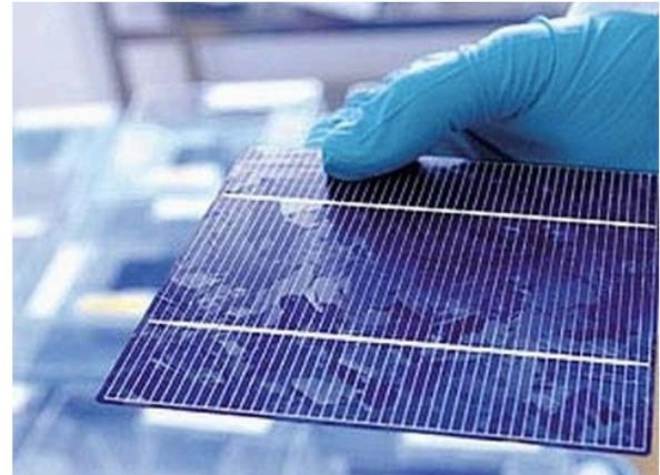
Figura 1.4 esempio di cella solare in silicio policristallino
